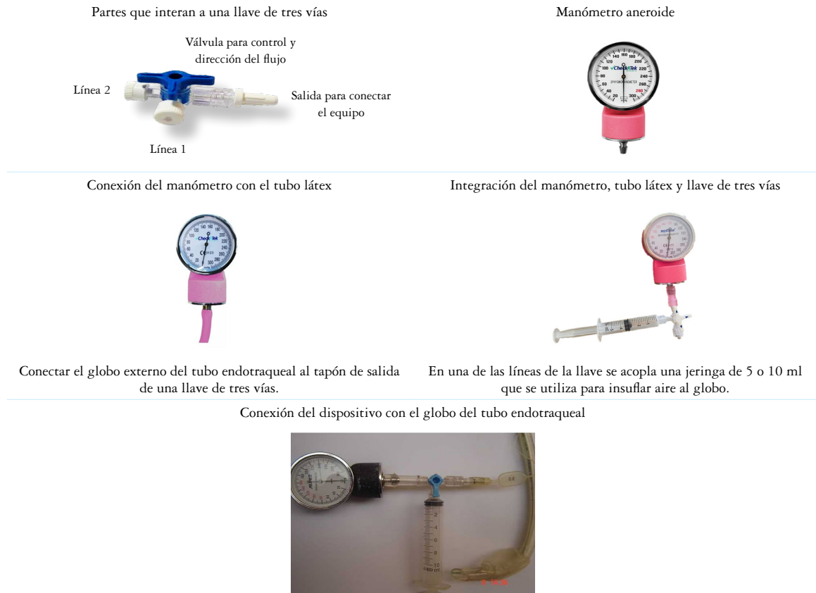
Figura 1. Dispositivo para la medición de la presión del neumotaponamiento
